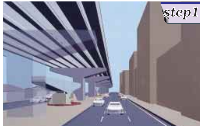
梁・隅角部の架設
